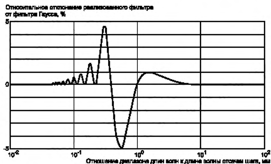
Рисунок 4 — Пример кривой отклонений реализованного фазокорректированного фильтра от Гауссова фильтра
