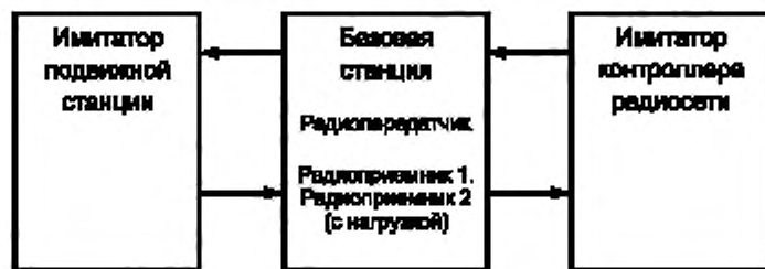
Рисунок 1 — Схема испытаний на помехоустойчивость базовой станции
