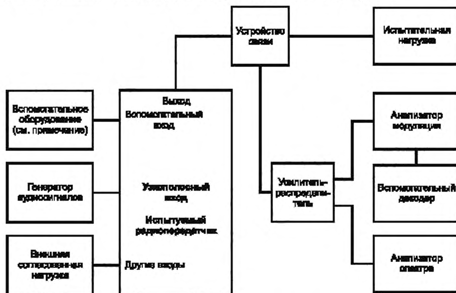
Рисунок 1 — Конфигурация оборудования при испытаниях: ЧМ радиовещательные передатчики
