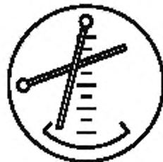
Рисунок 7б — Аналоговый дисплей особенно удобен для объединения нескольких однотипных шкал при одновременном считывании показаний с последующей реакцией. В качестве примера приведен индикатор самолета, одновременно указывающий отклонения от горизонтальной и вертикальной глассады
