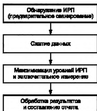
Рисунок 8 — Алгоритм проведения измерений
