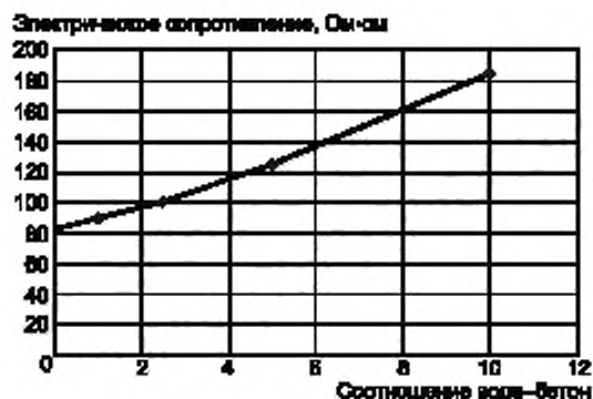
Рисунок 4 — Оценка электрического сопротивления водной вытяжки из бетона
