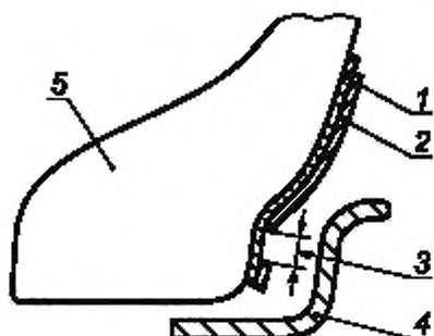
1 — стальные или медные прокладки толщиной 0,05 мм (0,002 дюйма); 2 — диэлектрическая изоляционная клейкая лента,
