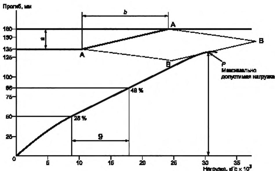
Рисунок 2 — Пример определения максимально допустимой нагрузки
