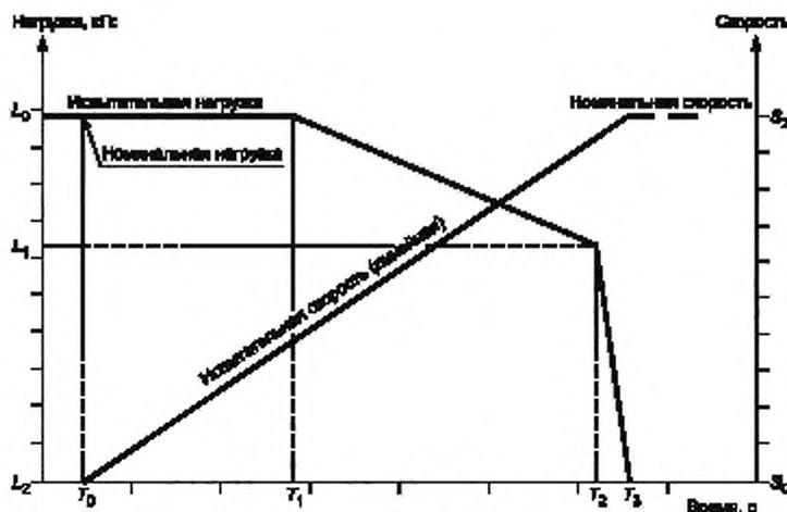
Испытательная нагрузка  $L_0$  должна быть равна или быть более номинальной нагрузки на шину. Скорость испытания  $S$  должна быть равна или быть более номинальной скорости шины  $L_1 = 0,65 L_0$ .  $T_1 = 20$  с,  $T_3 - T_2 = 3$  с максимально,  $RD$  (путь качения шины) = 1981 м
