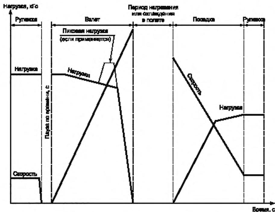
Рисунок 5 — Последовательность испытательного цикла — общий цикл
