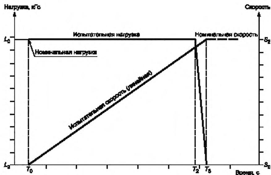
Испытательная нагрузка  $L_0$  должна быть равна или быть более номинальной нагрузки на шину. Скорость испытания  $S$  должна быть равна или быть более номинальной скорости шины  $L_1 = 0,65 L_0$ ,  $T_1 = 20$  с,  $T_3 - T_2 = 3$  с максимально, RD = 1981 м
