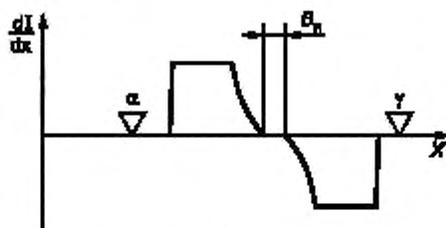
$X$  — ось абсцисс по 8.2.2;  $\alpha, \gamma$  — начальная и конечная точки положения зонда АСМ при сканировании поверяемого элемента, расположенные в соответствии с требованиями по 8.2.1;
