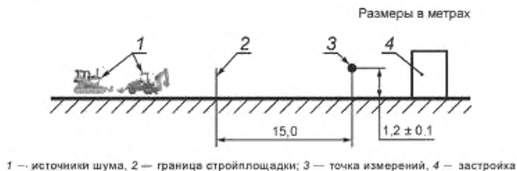
Рисунок 2 — Расположение точек измерений для строительных площадок на плоской поверхности (вид сбоку)
