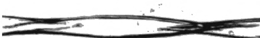
Рисунок 2 — Мертвое волокно (извитость менее выражена, но толщина стенки меньше, чем 1/5 от максимальной ширины ленты)
