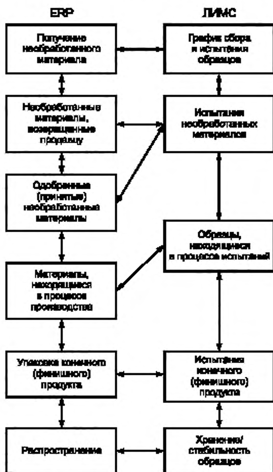
Рисунок 9 — Возможные пункты передачи данных между ERP и ЛИМС
