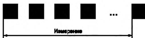
Рисунок 34 — Пример измерения шага пикселей
