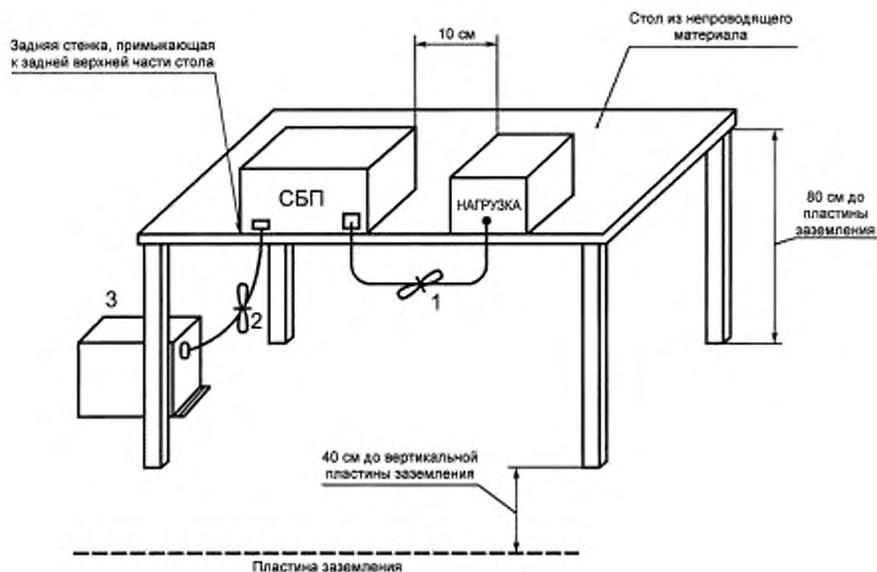
1 — кабели, которые висят на расстоянии менее 40 см от горизонтальной пластины заземления и не могут быть укорочены, укладывают в связки длиной от 30 до 40 см; 2 — излишки сетевого шнура укладывают в связку, расположенную в центральной части, или шнур укорачивают; 3 — СБП подсоединяют к эквиваленту сети, размещенному на расстоянии 80 см от СБП
