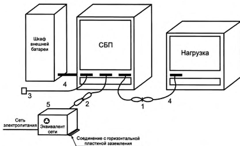
1, 2 — излишки кабелей укладывают в связки, расположенные в центральной части, или укорачивают; 3 — концы кабелей, которые не подключаются к внешним устройствам, нагружают на соответствующие сопротивления нагрузки; 4 — испытываемое оборудование и кабели изолируют (прокладкой толщиной 15 мм) от горизонтальной пластины заземления; 5 — испытываемое оборудование подсоединяют к эквиваленту сети
