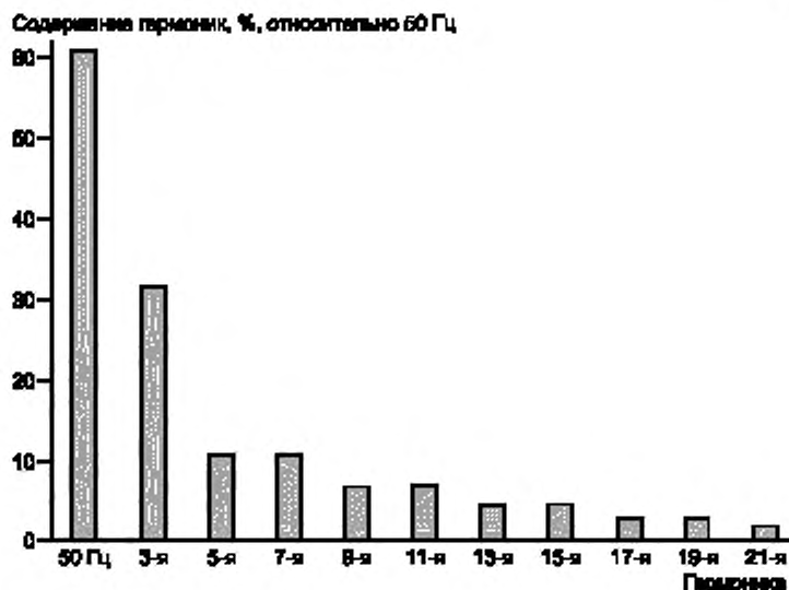
Рисунок А.6 — Распределение гармоник при фазовом управлении (анализ Фурье не завершен)
