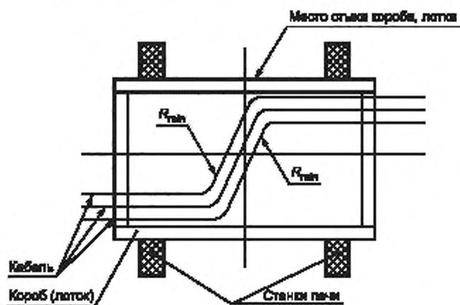
$R_{min}$  — минимальный радиус изгиба кабеля, мм, определяется в соответствии с технической документацией на кабель
