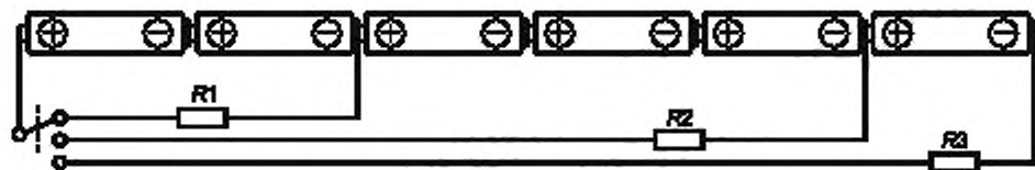
Рисунок В.13 — Пример дробного отведения напряжения при последовательном напряжении батареи
