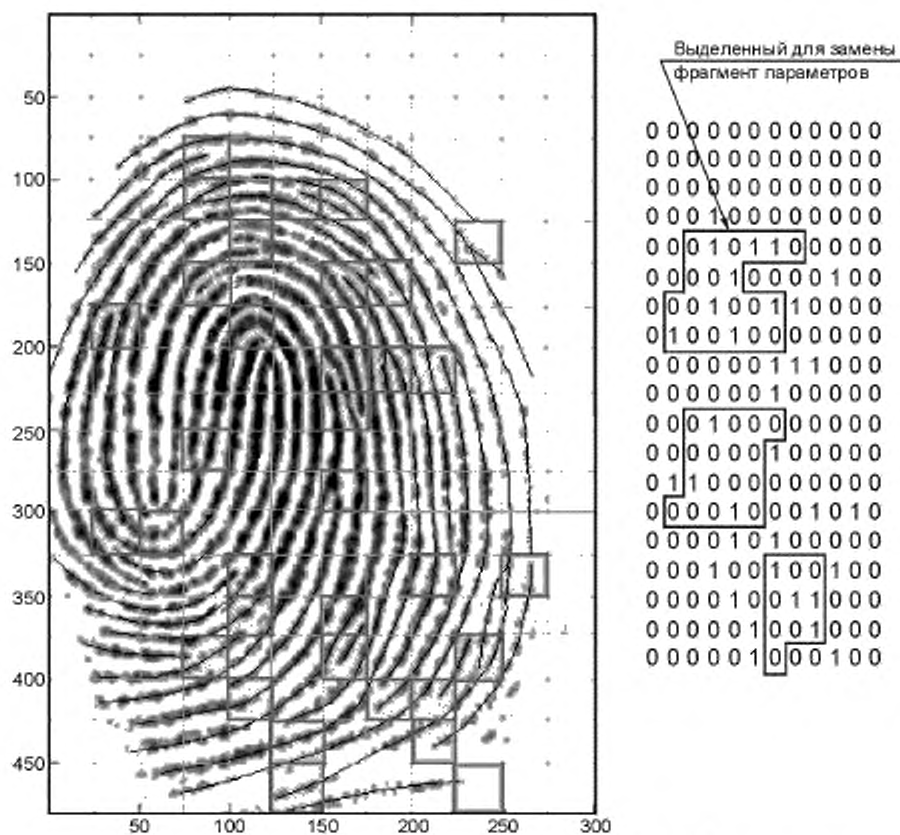
Рисунок В.1 — Выделение фрагментов вектора биометрических параметров изображения отпечатка пальца при размножении двух примеров
