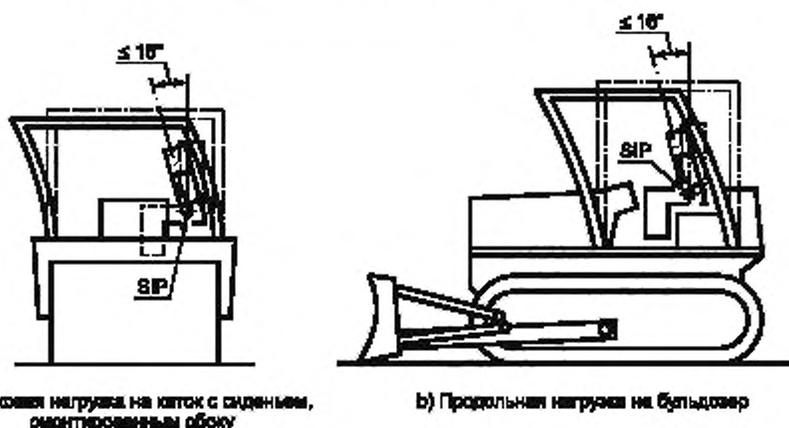
а) Боковая нагрузка на каток с сиденьем, смонтированным сбоку
