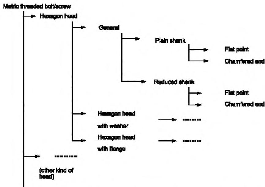
Metric threaded bolt/screw — болты/винты с метрической резьбой; Hexagon head — с шестигранной головкой, other kind of head — другие виды головок, General — общее; Hexagon head with washer — с шестигранной головкой и шайбой, Hexagon head with flange — с шестигранной головкой и фланцем, Plain shank — с цилиндрическим стержнем; Reduced shank — со стержнем уменьшенного размера; Flat point — с плоским окончанием; Chamfered end — со скошенным окончанием
