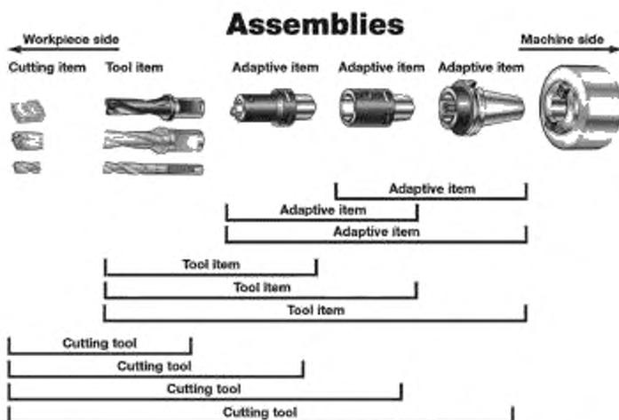
Workpiece side -- сторона обрабатываемой детали, Cutting item — режущий элемент, Tool item — рабочий элемент; Cutting tool — режущий инструмент, Adaptive item — присоединительный элемент, Assemblies — сборка режущего инструмента, Machine side — сторона металлорежущего станка
