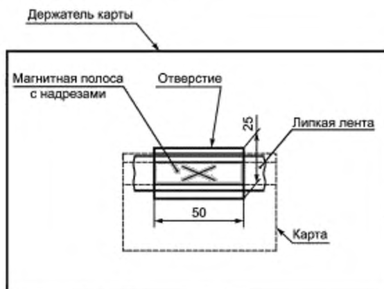
Рисунок 18 — Схема испытания магнитной полосы на адгезию
