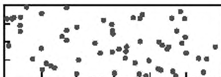
Рисунок А.6 — 4 процента поверхности, 61 пор, d = 1 мм
