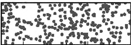
Рисунок А.9 — 16 процентов поверхности, 244 поры, d = 1 мм
