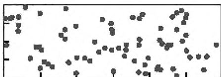
Рисунок А.7 — 5 процентов поверхности, 76 пор, d = 1 мм
