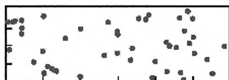
Рисунок А.5 — 3 процента поверхности, 45 пор, d = 1 мм
