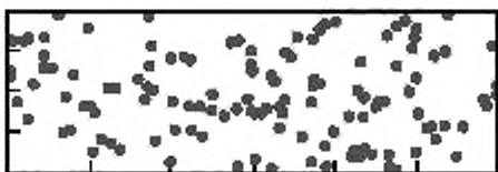
Рисунок А.8 — 8 процентов поверхности, 122 поры, d = 1 мм
