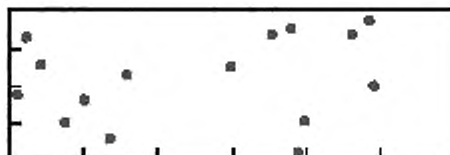
Рисунок А.1 — 1 процент поверхности, 15 пор, d = 1 мм
