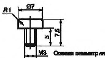
Верхняя часть центрального проводника. Нормализованная сталь. Приблизительно 2:1
