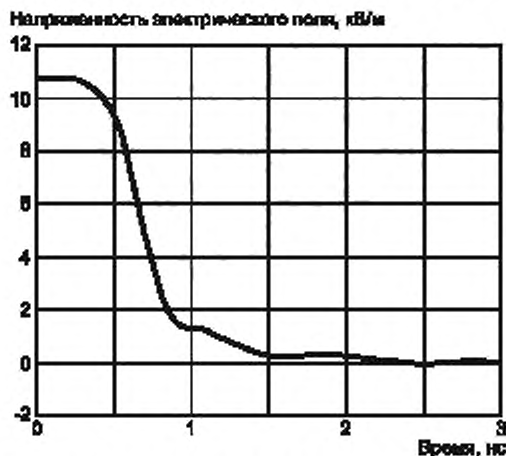
Рисунок D.1 — Зависимость от времени напряженности электрического поля при электростатическом разряде от человека, держащего металлический предмет, заряженный до напряжения 5 кВ. Измерения на расстоянии 0,1 м при длине дуги 0,7 мм и времени нарастания силы тока 850 пс
