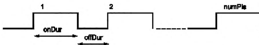
Рисунок 4 — Конфигурация выходных импульсов команды
