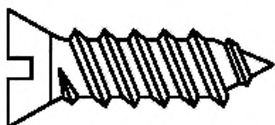
Рисунок 1 — Самонарезающий формующий винт (3.3.22)
