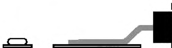
Рисунок 18 — Расплюснутые выводы отцентрированы на контактной площадке: заданное состояние
