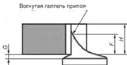
Рисунок А.25 — Галтель припоя: заданное состояние
