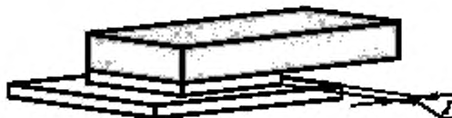
Рисунок 30 — Установка компонента с контактами на нижней поверхности: заданное состояние
