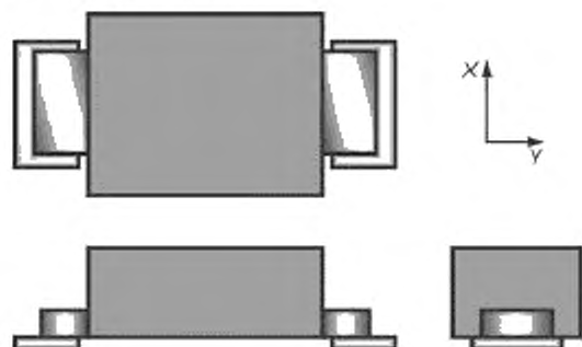
Рисунок 42 — Установка компонента большой мощности с плоскими выступающими выводами: заданное состояние
