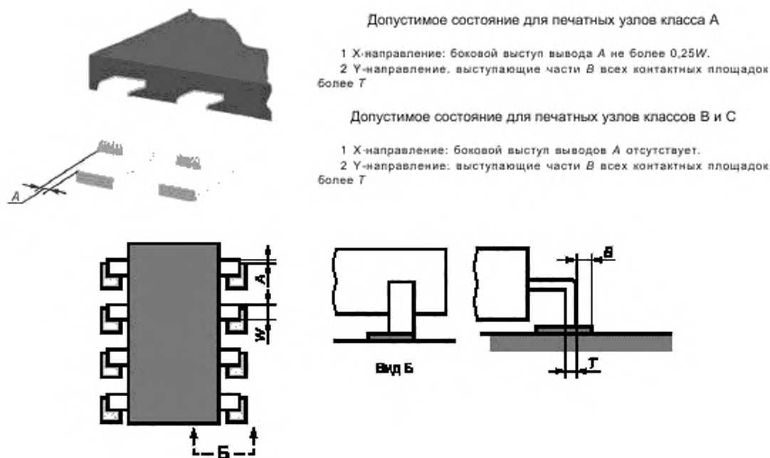
Рисунок 37 — Установка компонента с выводами для пайки встык: допустимое состояние
