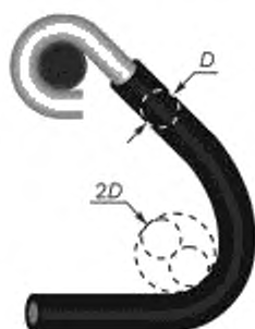
Рисунок 11 — Снятие напряжения с проволочного вывода: допустимое состояние
