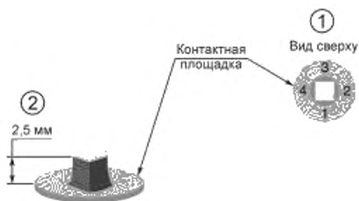
Рисунок 21 — Состояния подъема припоя: виды состояний
