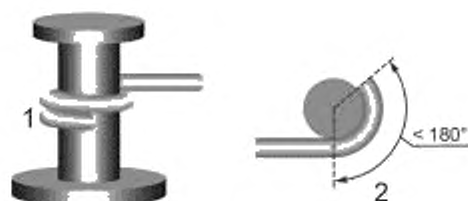
Рисунок 4 — Круговая накрутка провода и вывода: виды состояний
