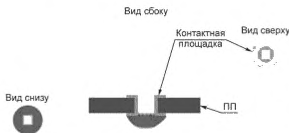
Рисунок 18 — Галтели припоя: допустимое состояние
