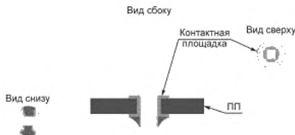
Рисунок 20 — Галтели припоя: недопустимое состояние
