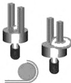
Рисунок 9 — Соединение контакта с нижней разводкой: допустимое состояние
