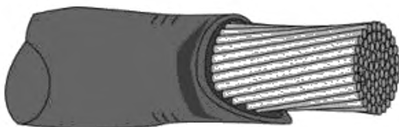
Рисунок 14 — Поврежденная изоляция: допустимое состояние
