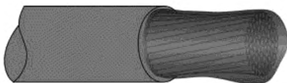
а) Лужение провода
