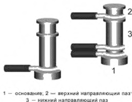
Рисунок 3 — Круговая накрутка провода и вывода: допустимое состояние
