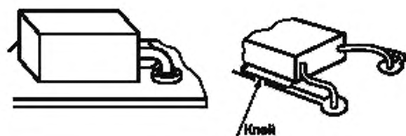
Рисунок А.4 — Боковой монтаж
