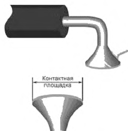
Рисунок 61 — Смачивание припоем: заданное состояние
