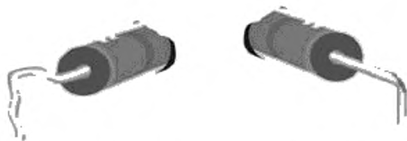
Рисунок 45 — Повреждение осевого вывода компонента: недопустимое состояние
