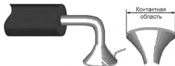
Рисунок 65 — Галтель припоя: заданное состояние
