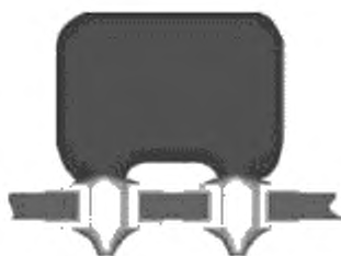
Рисунок 39 — Мениски покрытия, углубленные в отверстия: недопустимое состояние
