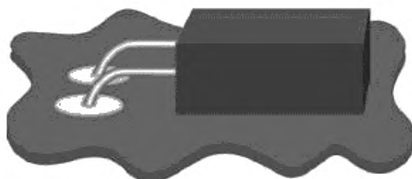
Рисунок 20 — Компонент с радиальными выводами, горизонтальный монтаж: заданное состояние
