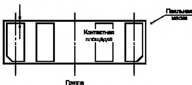
Рисунок 2 — Групповой монтаж без паяльной маски между контактными площадками
