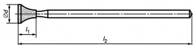
Рисунок 4 — Обратнo конусная (гиперболическая-обратная) головка
