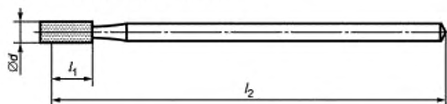
Рисунок 6 — Цилиндрическая, регулируемая головка
