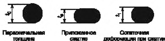
Рисунок 6 — Остаточная деформация при сжатии уплотнительного кольца
