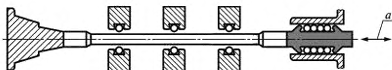
Рисунок 8 — Бурильная труба. Испытание по определению толкающего/тянущего усилия
