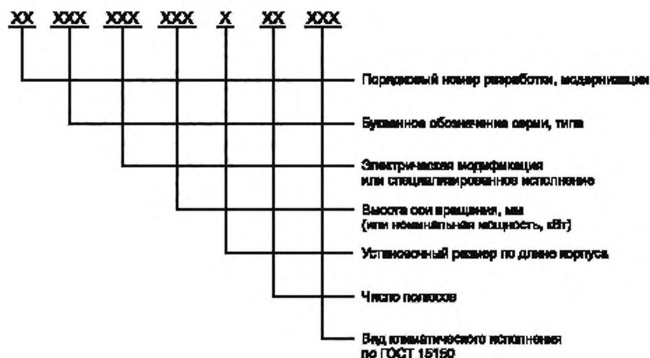
Примечание — Как правило, устанавливаются следующие буквенные обозначения серий, типов, модификаций: А — асинхронный; В — взрывозащищенный (или В — водяное охлаждение); Р — рудничный; М — для области применения по группе II (или М — повышенная мощность); Б — необдуваемое, К — для конвейеров или угольных комбайнов.
