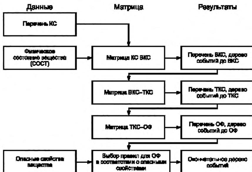
Рисунок 4 — Схема шагов построения дерева событий
