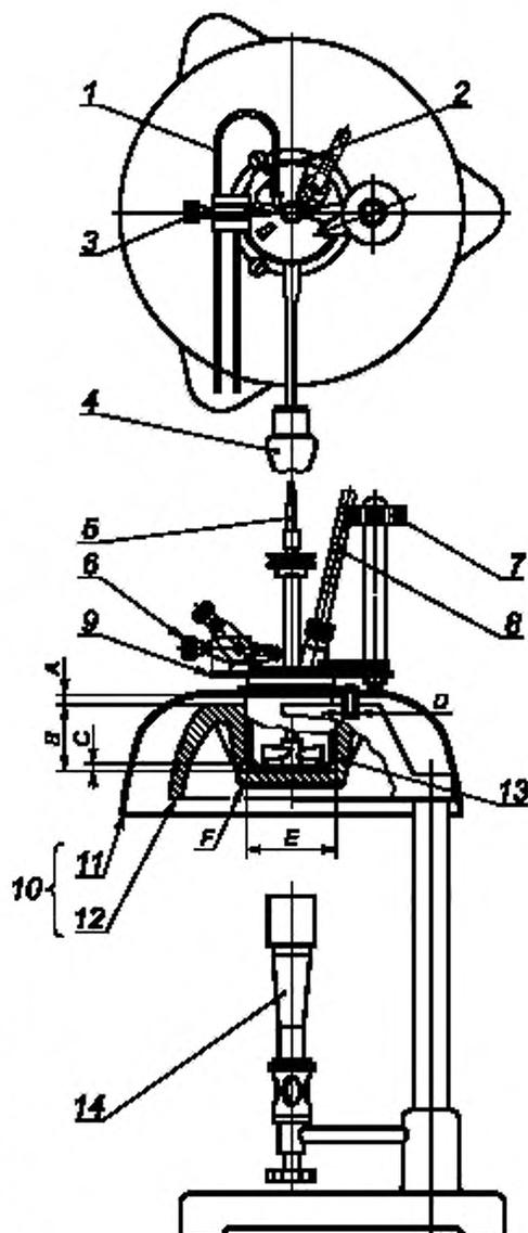
Рисунок А1.1 — Аппарат Пенски-Мартенса с закрытым тиглем
