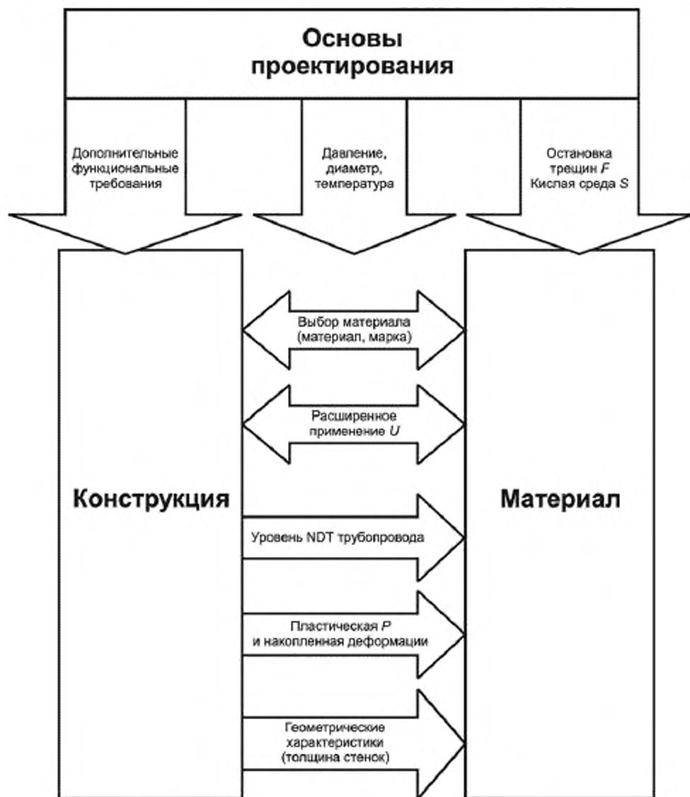
Рисунок 15.3 — Основные связи материала и конструкции
