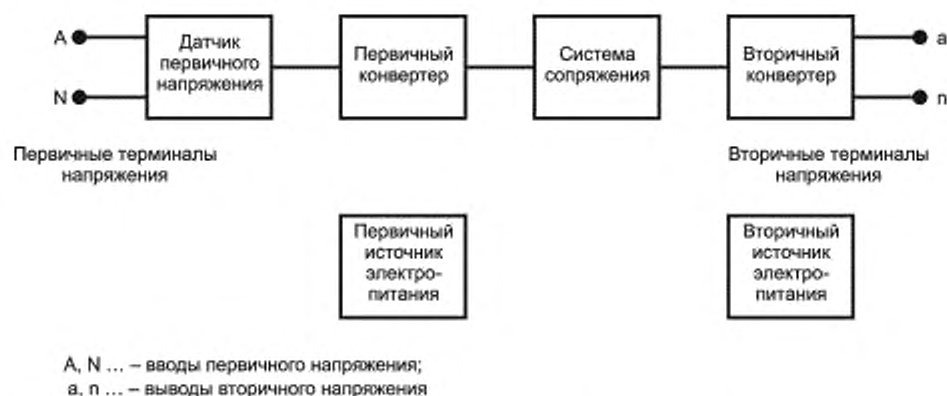
Рисунок 1 — Блок-схема заземляемого однофазного ЭТН
