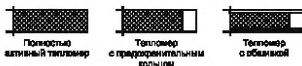
Рисунок К.3 — Разрез различных тепломеров (измерителей теплового потока) (разрез по радиусу)
