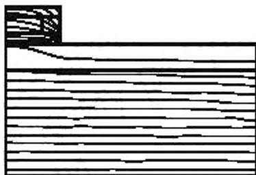
Рисунок 4 — Изотермы ( \delta\theta = 0,05 \text{ }^\circ\text{C} ) для установленного на стене тепломера, обшитого и защищенного (цилиндрическое сечение)
