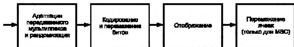
Рисунок 3 — Функциональная блок-схема кодирования и перемежения
