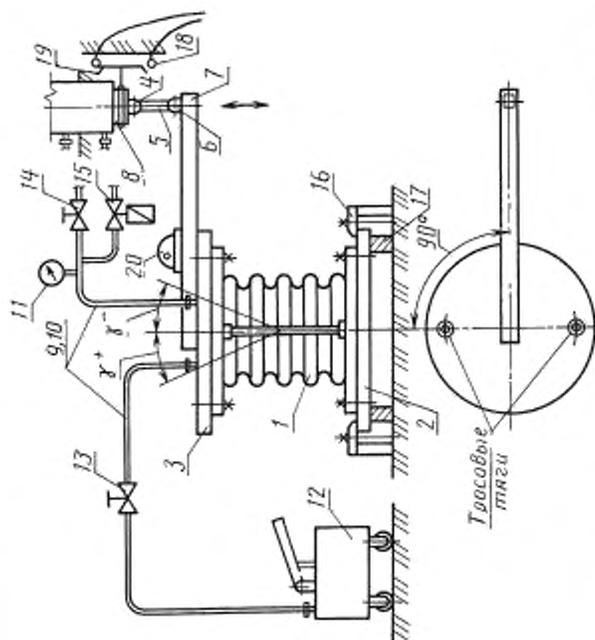
1 — компенсатор сдвигонный; 2 — заглушка нижняя; 3 — заглушка верхняя; 4, 6 — серыга; 5 — переходник; 7 — балка; 8 — шток гидроцилиндра; 9, 10 — шланг гибкий; 11 — манометр; 12 — насос; 13, 14 — клапан запорный; 15 — клапан предохранительный; 16 — прижим; 17 — подставка; 18 — выключатель концевой; 19 — планка нажимная; 20 — клапанг оптический
