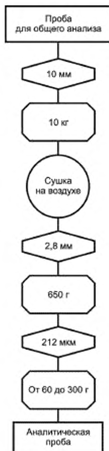
Рисунок 11 — Пример схемы приготовления пробы для общего анализа
