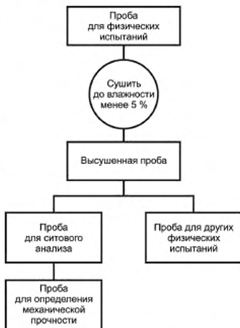
Рисунок 13 — Пример схемы приготовления проб для ситового анализа и/или для других испытаний
