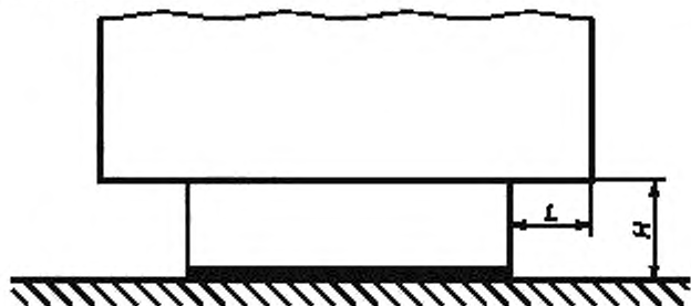
Рисунок А.20 — Размещение машины на полу с возможностью доступа в пространство L
