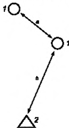
1 — пункт подвижного приемника; 2 — опорный пункт; а — минимальное расстояние 2 м (не должно превышать 20 м); б — расстояние от опорной станции, соответствующее поставленной задаче
