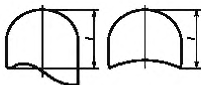
Рисунок 4 — Измерение длины каблука и набойки
