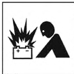
Рисунок А.44 — Взрыв аккумуляторной батареи
