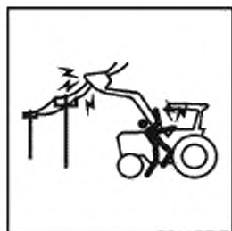
Рисунок А.5 — Электрошок или поражение электрическим током. Погрузчик
