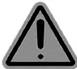
Рисунок 9 — Главный предупреждающий знак безопасности
