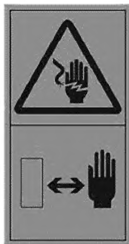
Рисунок С.15 — Электрошок или поражение электрическим током. Держи руки на безопасном расстоянии от источника электроэнергии
