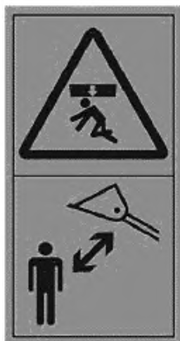
Рисунок С.30 — Раздавливание тела. Стой на безопасном расстоянии от поднятой стрелы или ковша
