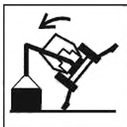
Рисунок А.41 — Опрокидывание машины. Перегруз. Экскаватор-погрузчик
