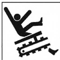
Рисунок А.36 — Затягивание или травматическая ампутация ноги или ступни. Траншеексплатор
