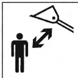
Рисунок В.4 — Стой на безопасном расстоянии от поднятой стрелы и ковша погрузчика
