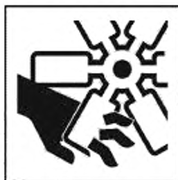
Рисунок A.24 — Травматическая ампутация пальцев или кисти. Вентилятор двигателя
