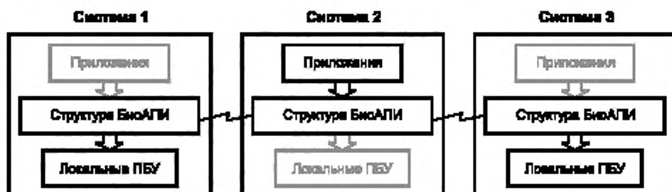
Рисунок 3 — Применение ПМО для контакта между системами
