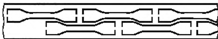
Рисунок 15 — Образцы, вырубленные ножом с выемкой
