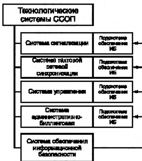
Рисунок 4 — Взаимосвязь СОИБ с технологическими системами ССОП
