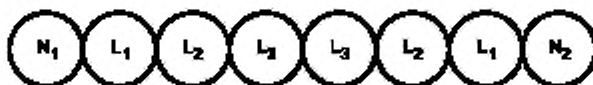
Рисунок Н.52.1 — Специальная конфигурация для шести параллельных одножильных кабелей в горизонтальной плоскости (см. 523.7)
