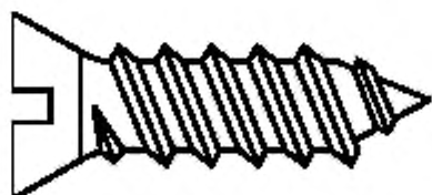
Рисунок 1 — Самонарезающий формирующий винт
